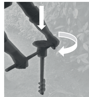
Premi e gira (su terreni duri, premere e attivare il foro) Press and turn (in hard soils, press and turn on the hole)
