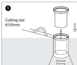
**IT** Realizzare il foro nel pavimento e posizionare la controcassa. Passate il cavo di alimentazione nell'apposito scasso presente. Posizionare la controcassa in modo che la parte superiore dell'apparecchio sia al livello del pavimento. Una posizione più alta del corpo illuminante può ostacolare la circolazione nella zona in cui è montato, mentre una posizione inferiore può agevolare la stagnazione e l'infiltrazione dell'acqua su questo.
