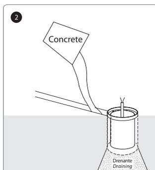
**IT** Dopo il posizionamento corretto della controcassa, inserire calcestruzzo per il completo fissaggio.
